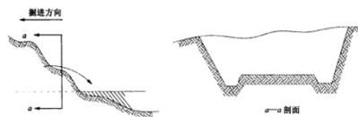
图1 单层横向全宽挖掘法
